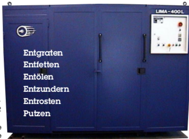
Somit werden die Teile erst entölt und getrocknet. Erst nach diesem Vorgang schaltet sich automatisch die Staubabsauganlage zu, um das Sägemehl aus der Trommel zu saugen.
