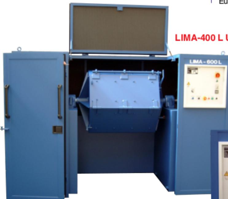
Die neuen Entgratungsmaschinen sind mit einem Einhebel-Trommel-Schnellverschluß zum schnellen Öffnen und Schließen der Trommel-Klappe ausgestattet.
